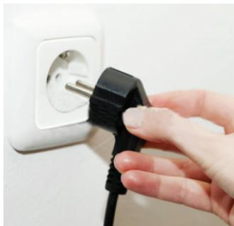
Перед началом любых работ отключите электропитание очистителя и выньте штепсельную вилку из сетевой розетки.
