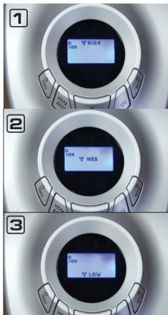
Выберите режим интенсивности очистки, нажав на кнопку MODE (M)
