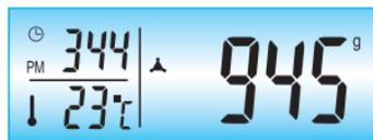
6. Если Вы хотите взвесить продукт в емкости – установите ее на платформу весов. Для сбрасывания массы емкости нажмите один раз на кнопку **TARE**.
